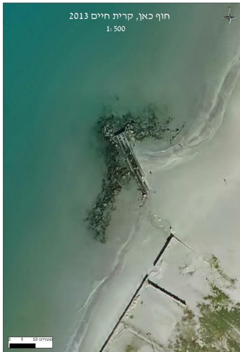
תמונה 4- תופעה מקומית של הצטברות חול במעלה הזרם, מצפון לאלמנט המוצב במים. חוף כאן, קרית חיים 2013 (Sarid 2019)
